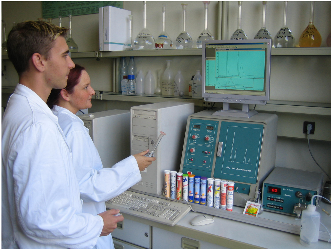
Constanze Walz und Marc-Markus Wiechers bei der Durchführung der Natriumbestimmung in Nahrungsergänzungsmitteln mit einem Ionenchromatographen der Firma Metrohm. Die Firma Metrohm ist Industriepartner der TBS 1 und unterstützt die Chemieausbildung.
