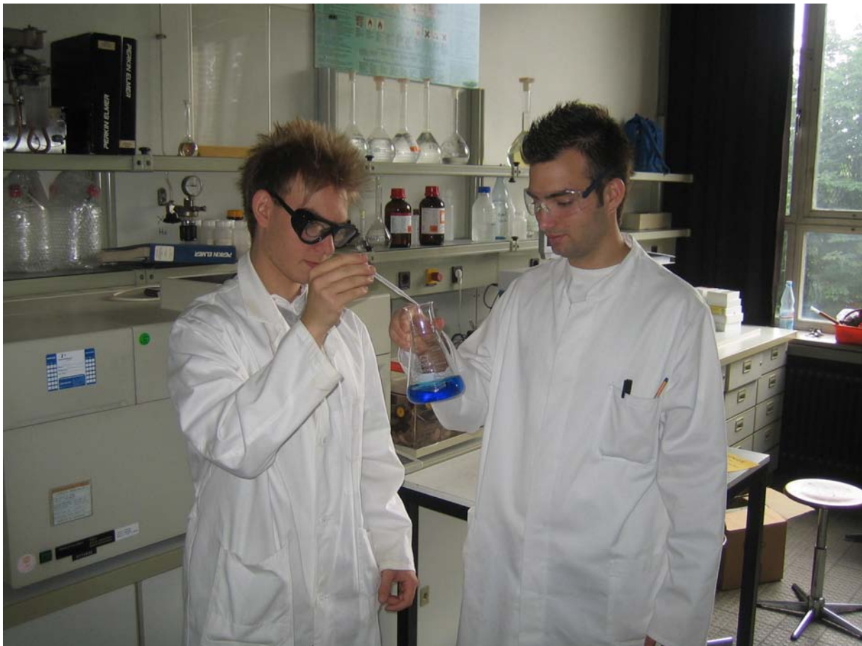
Philipp Rausch und Jan Wieczorek (v.l.) demonstrieren den Nachweis von Cyanid als Berliner Blau in einer stark verdünnten cyanidhaltigen Lösung.
